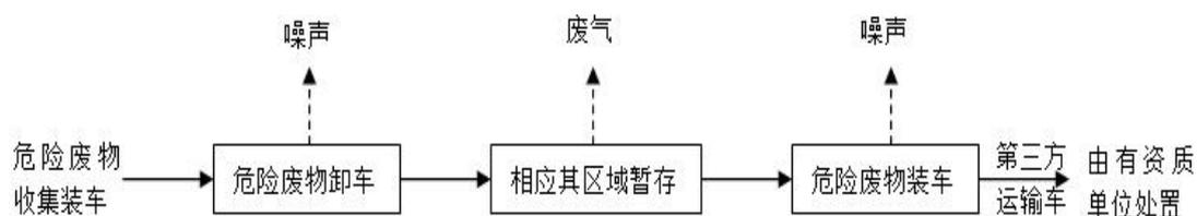
图3 工艺流程及产污节点图
